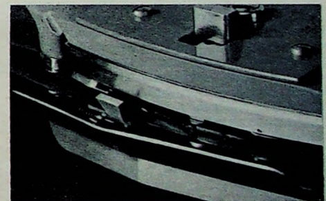
Universal-Studio-Kopfträger „206“ mit Band-Schneidvorrichtung (Vollmer); oben: bei Aufnahme und Wiedergabe, unten: Beginn des Bandschnitts nach Betätigung der Schneidtafel
